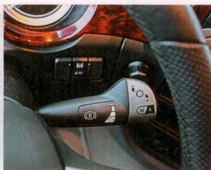
Правый подрулевой переключатель управляет ручным переключением АКП
