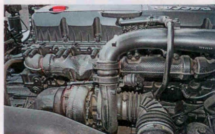
У дизеля PACCAR MX Евро-5 турбина проще, но тоже с электроникой
