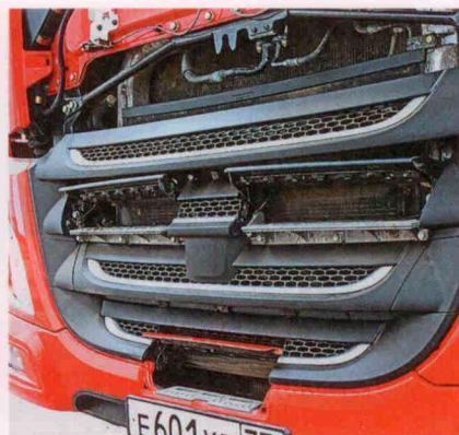
В облицовке и бампере DAF XF обязательно делают складывающиеся ступени для лучшего доступа к лобовому стеклу. Это действительно удобно
