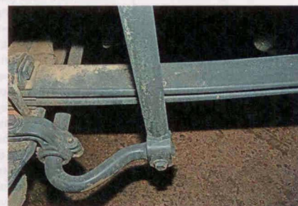
Передняя подвеска – на двухлистных параболических рессорах
