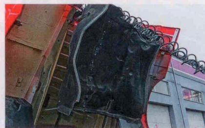
К полу кабины закреплена капсульная шумоизоляция из слоистого полимера
