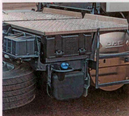
На DAF XF105 бак AdBlue, АКБ и глушитель смонтированы рядом
