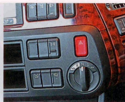
Контроллер коробки-«робота» установлен на панели приборов
