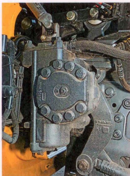
На машинах Евро-5 и Евро-6 стоят разные гидроусилители руля
