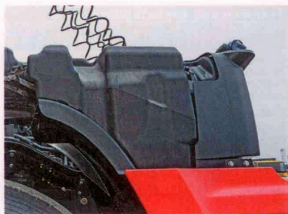
На DAF XF 105 Евро-6 очень интересно расположен резервуар для AdBlue
