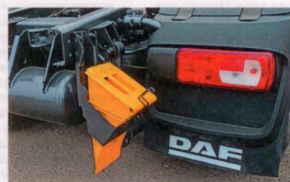
Для противоподкатных башмаков нашлось место на заднем свесе рамы
