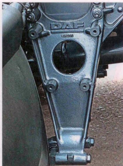
Соединения нижних реактивных штанг – на сайлентблоках, не требующих ТО
