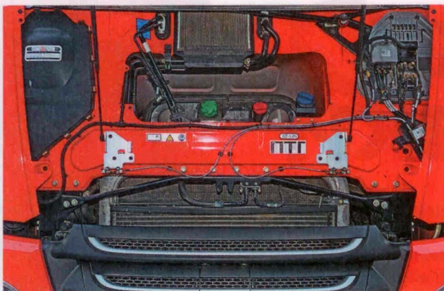
На современном DAF XF105 удобнее заливать жидкость в омыватель лобового стекла: за панелью есть горловина
