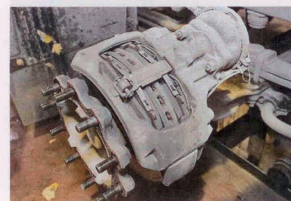
С дисковыми тормозами проще и быстрее менять тормозные колодки
