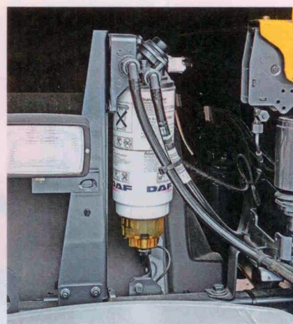
Топливный фильтр-отстойник с насосом и электроподогревом
