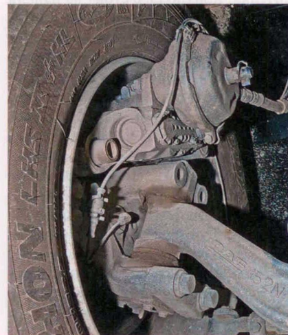
На балке передней оси написано: DAF. Балки двух вариантов: 7,5 и 8,0 т
