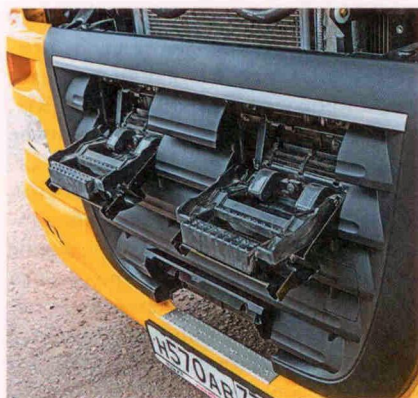
В облицовке и бампере DAF XF обязательно делают складывающиеся ступени для лучшего доступа к лобовому стеклу. Это действительно удобно
